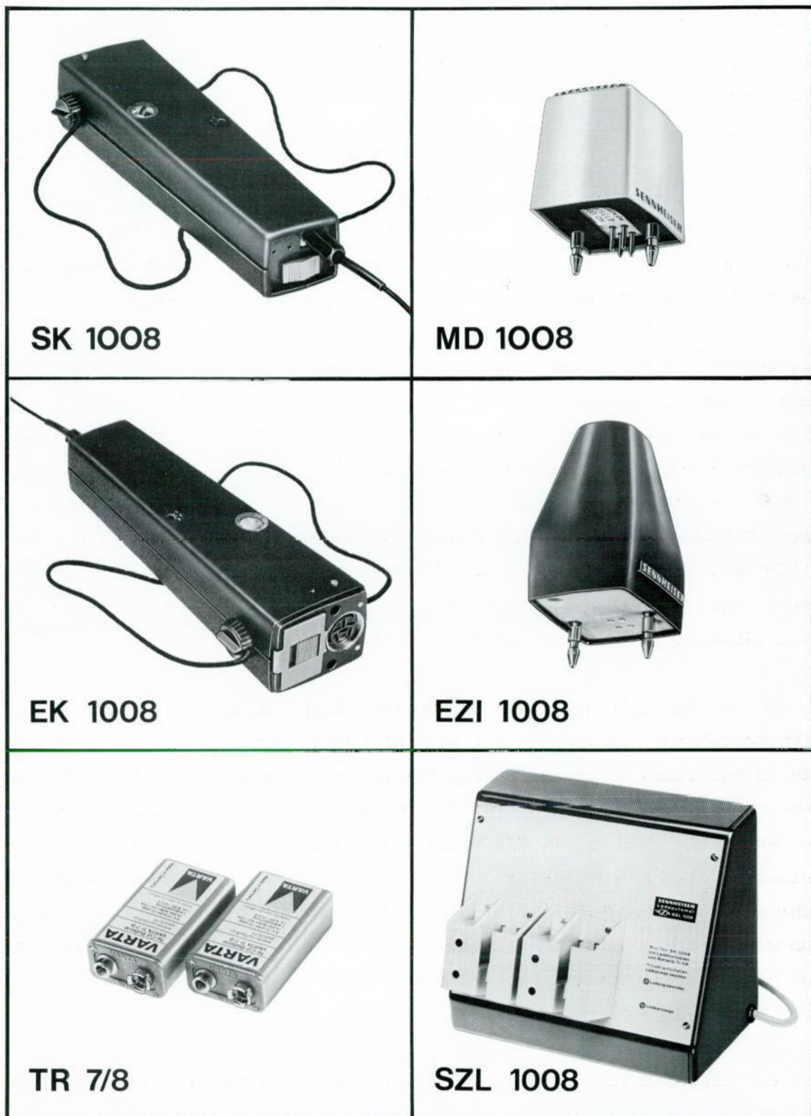
Bild 9 : Lieferumfang der vollständigen Anlage aus Mikroport-Sender SK 1008 nebst Aufsteckmikrofon MD 1008, Mikroport-Umhängeempfänger EK 1008 nebst Aufsteck-Induktionsspule EZI 1008, zwei Deac-Sammlern Tr 7/8 sowie vollautomatischem Ladegerät SZL 1008
