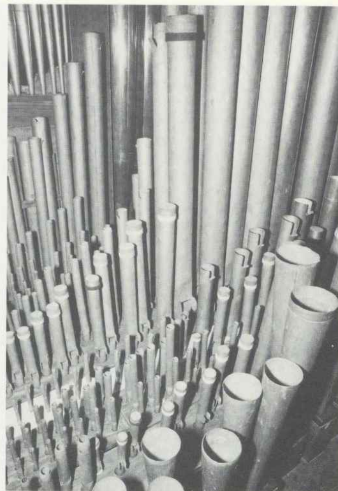
ABBILDUNG 148 Ein Blick auf den heutigen Pfeifenbestand: Ganz hinten sind die Prospektpfeifen zu sehen. Dann folgen: restliche Pfeifen des Principal 8', Mixtur 3-fach, Octave 2', Quinte 2 2/3', Octave 4', Gedackt 8', Quinte 1 1/2' (neues Rastbrett), Waldflöte 2', Sesquialtera 2-fach, Flöte 4', Trompete 8'
