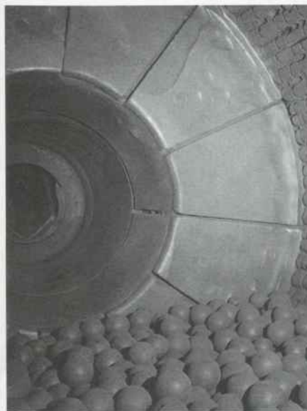
Abb. 70: Vormühle mit Henricot-Panzerung, 1952/53
